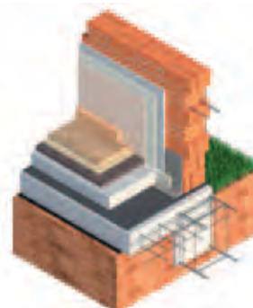
ENCUENTRO DE MURO EXTERIOR CON SUELO
