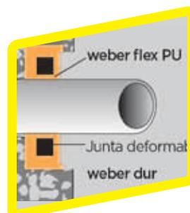
Colocar una junta estanca alrededor del tubo y sellarla con weber flex PU deformable. Rellenar con weber dur.
