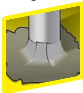
Tratar todos aquellos elementos que atraviesen o interrumpan nuestra barrera impermeable, como las ventilaciones de las instalaciones, para evitar filtraciones.
