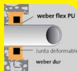
Colocar una junta estanca alrededor del tubo y sellarla con weber flex PU deformable. Rellenar con weber dur.
