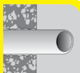
Perforar la pared (ligeramente superior al diámetro del tubo por colocar). Descarnar los bordes formando una abertura de 1x4 cm. Eliminar el polvo y limpiar. Colocar el tubo.
