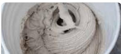
Colocar agua limpia en el balde, luego agregar weber mármol paulatinamente (6 l por bolsa aprox.) Mezclar hasta obtener una pasta homogénea. Dejar reposar.
