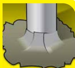
barrera impermeable, como las ventilaciones de las instalaciones, para evitar filtraciones.
