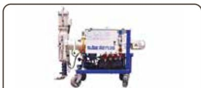
Proyectado: regular caudal a 650 -750 l/h. Aproximadamente hasta obtener la consistencia adecuada. Asegurar un caudal de agua constante para la máquina.
