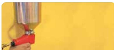
Proyectar en una sola mano con máquina tolva. Utilizar compresor a diafragma continuo o compresor de tanque de recuperación rápida con regulador de salida (35 lbs/pulg<sup>2</sup>).
