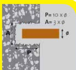
Realizar la regata del anclaje. Limpiar y eliminar el polvo. Verificar que la profundidad y el ancho sean correctos con respecto al diámetro del anclaje.
