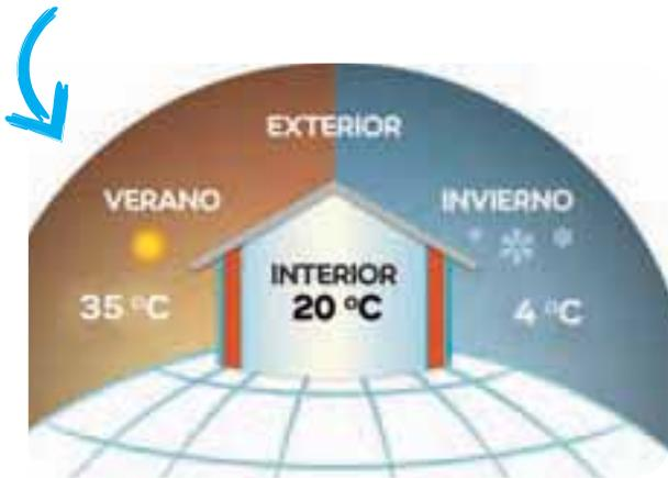
Entre las diferentes soluciones de aislamiento térmico en edificios, los **sistemas webertherm** de aislamiento térmico por el exterior (EIFS) son la mejor opción, puesto que permiten tratar el 100 % de los puntos débiles energéticamente de manera envolvente, gracias al hecho de añadir una piel extra a la fachada.
