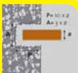
Realizar la regata del anclaje. Limpiar y eliminar el polvo. Verificar que la profundidad y el ancho sean correctos con respecto al diámetro del anclaje.
